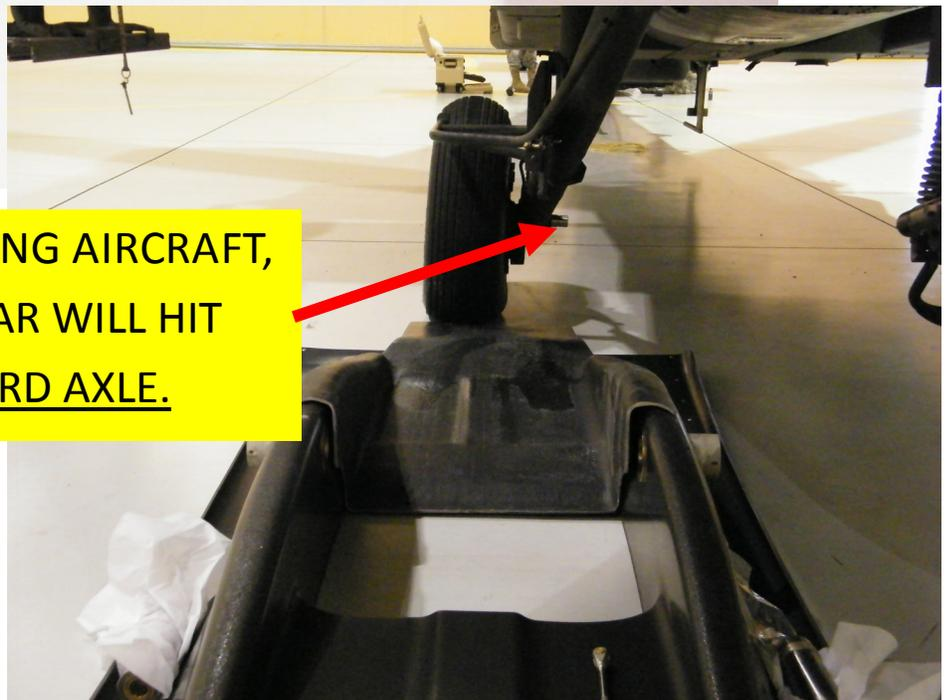
**WARNING:** PRIOR TO TOWING AIRCRAFT, VERIFY NO PORTION OF GEAR WILL HIT SKI. ESPECIALLY THE INBOARD AXLE.
